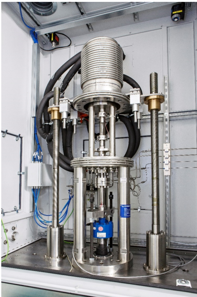
Versuchseinrichtung zur Durchführung von temperierten Ermüdungsversuchen unter Druckwasserstoff und Stickstoff im Fraunhofer LBF. Foto: Fraunhofer LBF, Raapke
