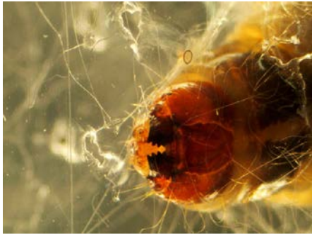
Fraßspuren der Raupe in einer PE-Folie Fotos: Fraunhofer LBF
